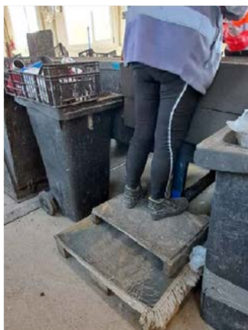
Stanowiska sortowania wyposażone w podesty ułatwiające dostęp do segregowanych odpadów, podesty wykonane z płyt meblowych, paździerzowych niezmywalnych, przykryte dywanikami.
