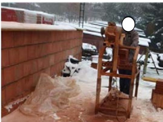
Eksploracja stołowej pilarki tarczowej do pustaków ceramicznych. Pracownik dokonujący cięcia pustaków nie był wyposażony w indywidualne środki ochrony oczu, słuchu, dróg oddechowych oraz hełm ochronny. Ponadto sama pilarka nie posiadała osłony przekładni pasowej napędu.
