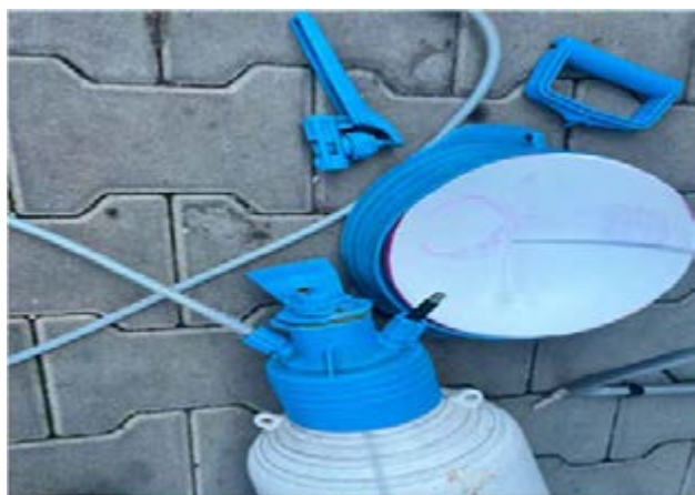
Na zdjęciu widoczny zawór/ wentyl umożliwiający „pompowanie” zbiornika ciśnieniowego z pominięciem ręcznej pompy stanowiącej wyposażenie opryskiwacza wstawiony w miejsce zaworu bezpieczeństwa
