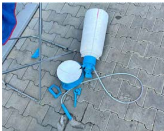
Uszkodzony opryskiwacz na skutek rozerwania
