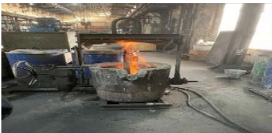
Kadzie do transportu ciekłego metalu wygrzewane palnikami gazowymi podłączonymi bezpośrednio do sieci gazowej bez urządzenia odcinającego dopływ gazu w momencie spadku ciśnienia lub zgaśnięcia płomienia
