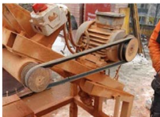
Eksploracja stołowej pilarki tarczowej do pustaków ceramicznych. Pracownik dokonujący cięcia pustaków nie był wyposażony w indywidualne środki ochrony oczu, słuchu, dróg oddechowych oraz hełm ochronny. Ponadto sama pilarka nie posiadała osłony przekładni pasowej napędu.
